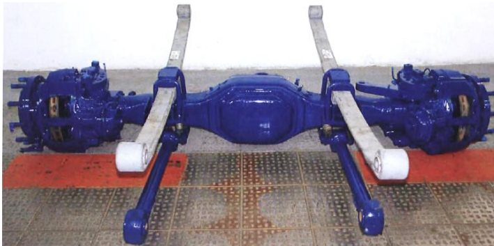
Obr. 5: Zadní tuhá náprava z vozu Kamaz 4911 [16, s. 54]
