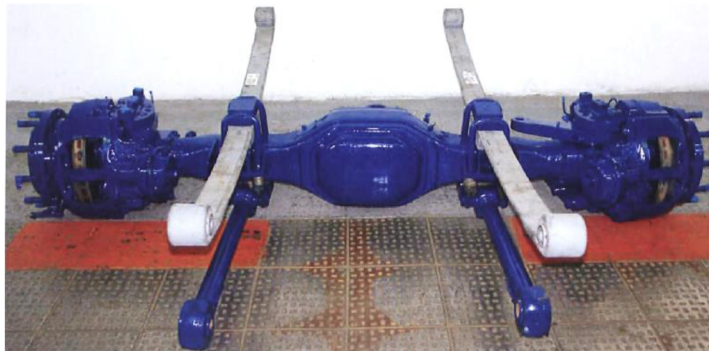
Obr. 5: Zadní tuhá náprava z vozu Kamaz 4911 [16, s. 54]
