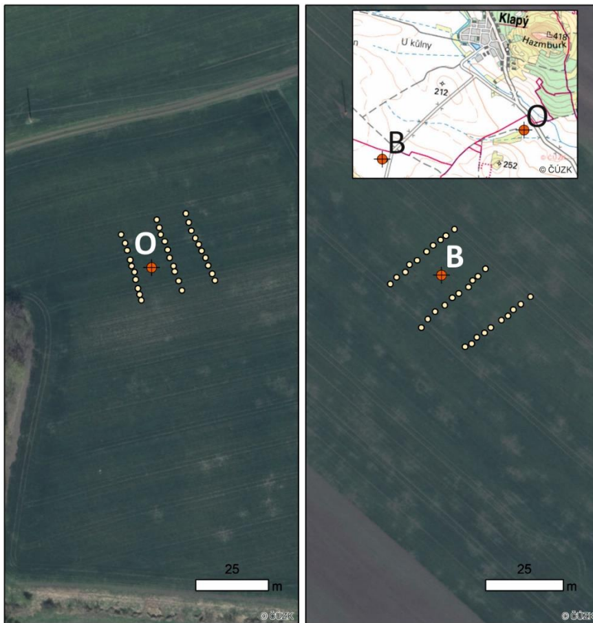
Obrázek 14. Znázornění jednotlivých míst vpichů penetrometrem (žluté body) a místo kopané sondy (červený terč) na bezorebné technologii (B) a technologii orebné (O) se znázorněním jednotlivých pozemků v pravém horním rohu.
