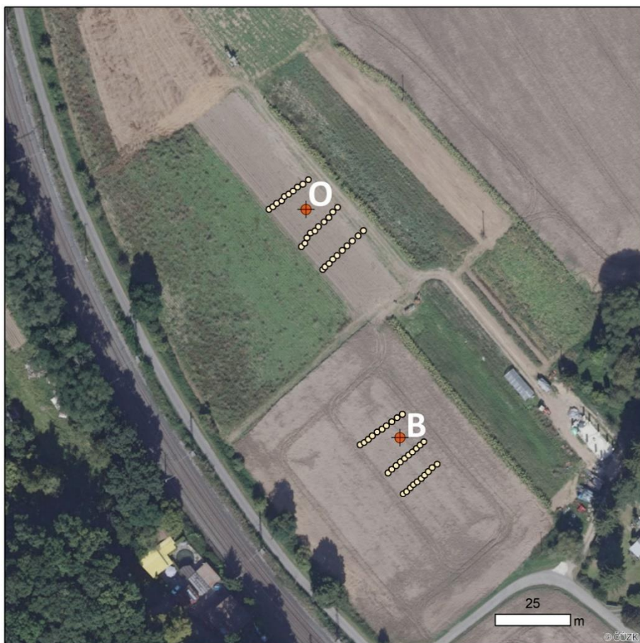
Obrázek 12. Znázornění jednotlivých míst vpichů menetrometrem (žluté body) a místo kované sondy (červený terč) na bezorebné technologii (B) a technologii orebné (O).
