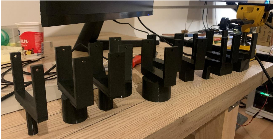
Obrázek 48 - Úchyty pro závaží o různých průměrech (válcové a hranolové)
