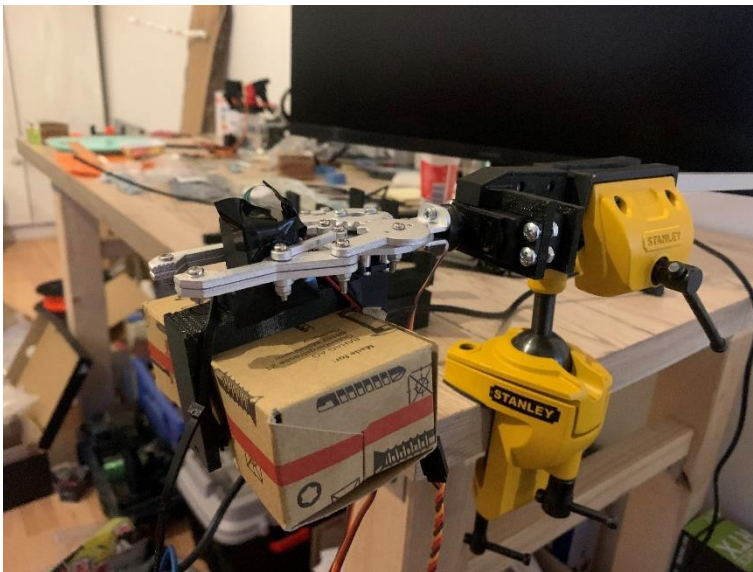
Obrázek 53 - Test síly stisku (20 mm, 350 g)
