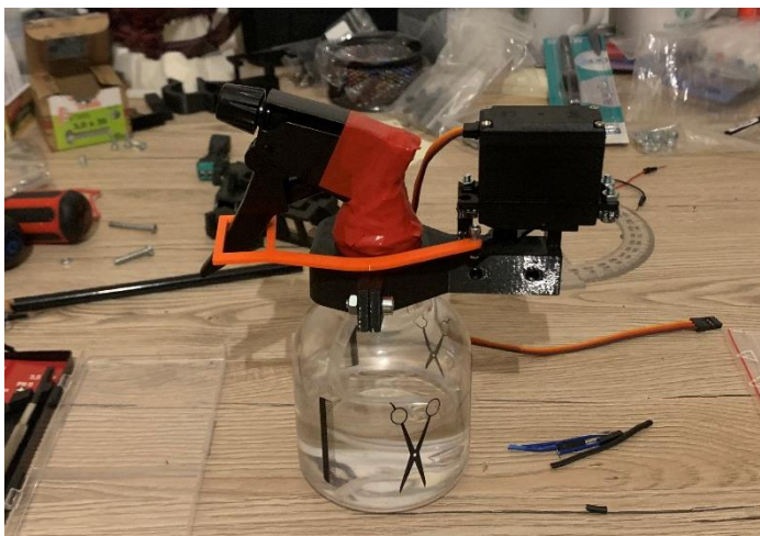
Obrázek 25 - Kompletní EF s rozprašovačem
