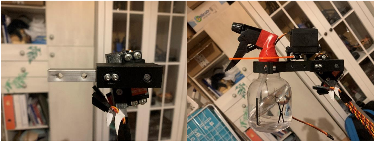
Obrázek 22 - Otevřené rameno L3 a EF s rozprašovačem
