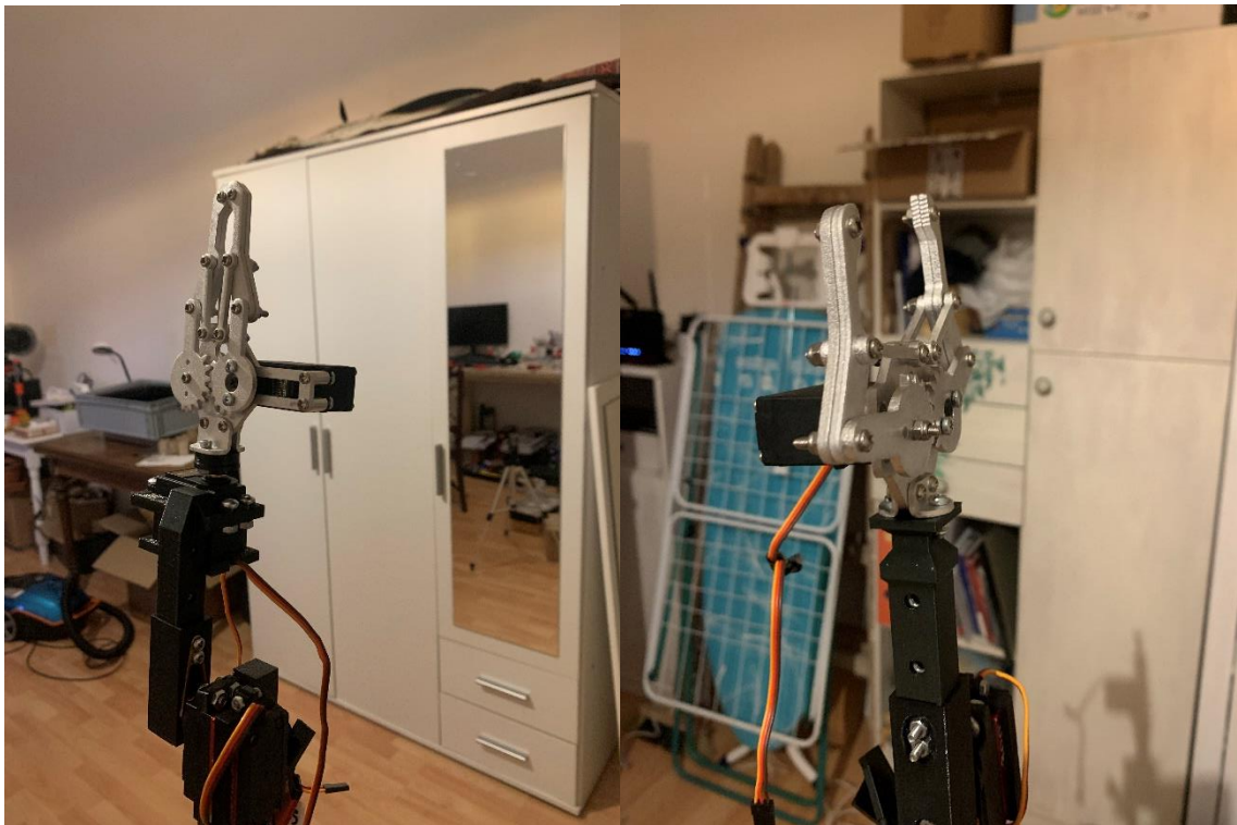
Obrázek 23 - EF s rotačními čelistmi (vlevo) a statickými (vpravo)
