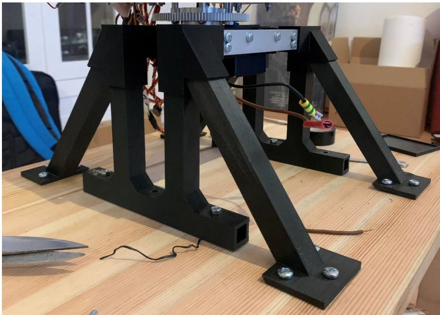
Obrázek 20 - Foto PETG základny s umístěným servem
