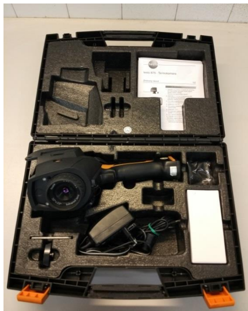
Figure 13. Thermal imager Testo 875
