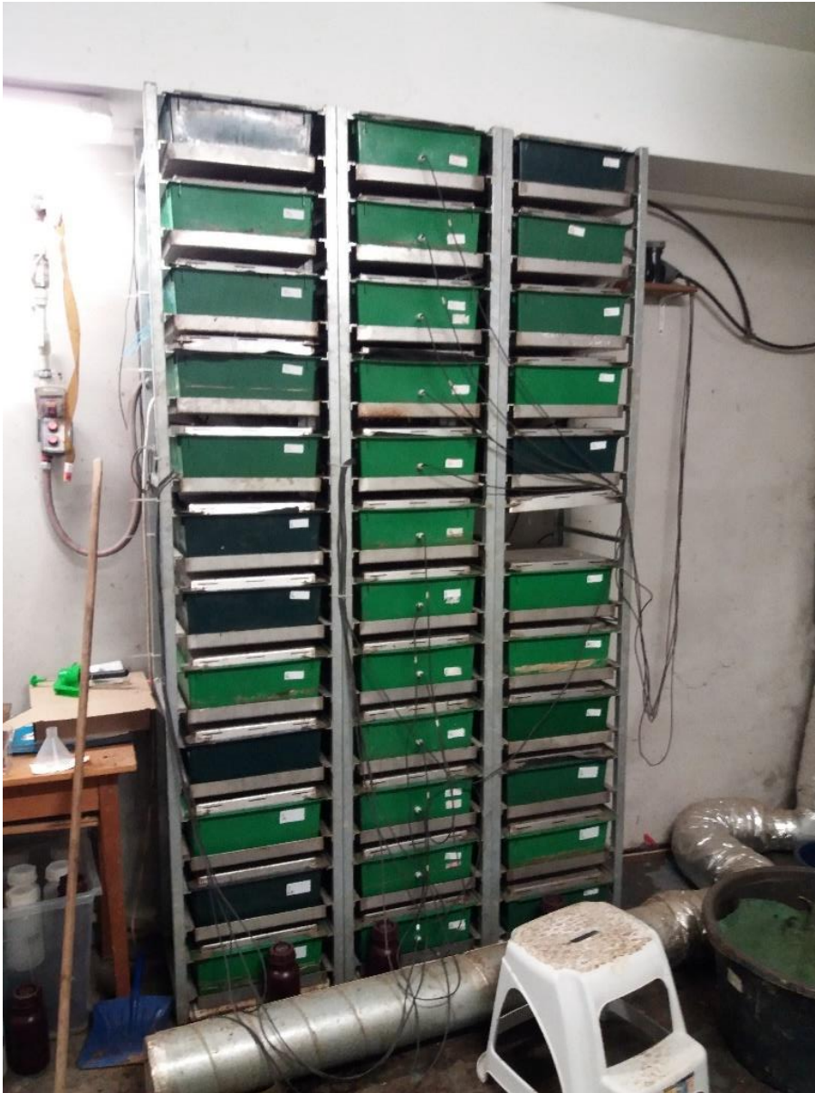
Obrázek č. 1 – Kovová konstrukce s plastovými vermikompostovacími miskami (Výzkumná stanice Červený Újezd), (zdroj: Bc. Nikola Kozlíková)
