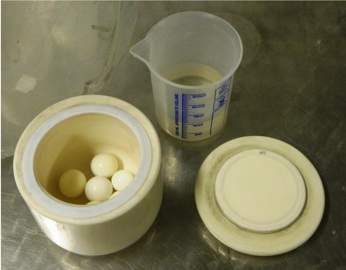
Obrázek č. 15: Mlecí nádoba a mlecí elementy použité na mletí u první sady vzorků.
