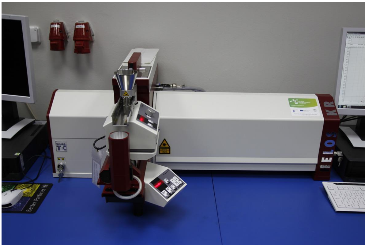
Obrázek č. 17: Analyzátor velikosti částic HELOS/KR Multirange od společnosti Sympatec GmbH. [62]
