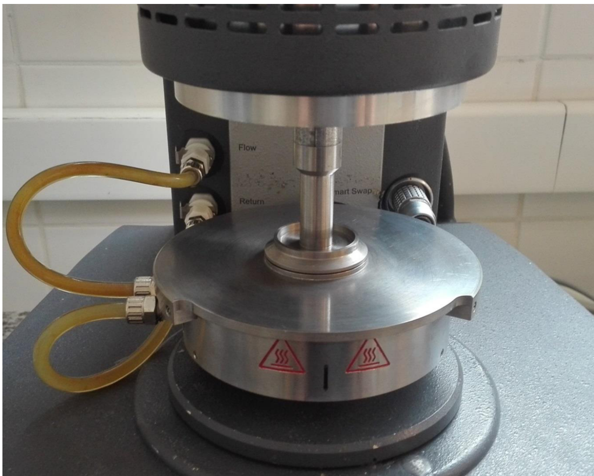
Obrázek č. 24: Geometrie deska-deska pro měření tokových křivek.
