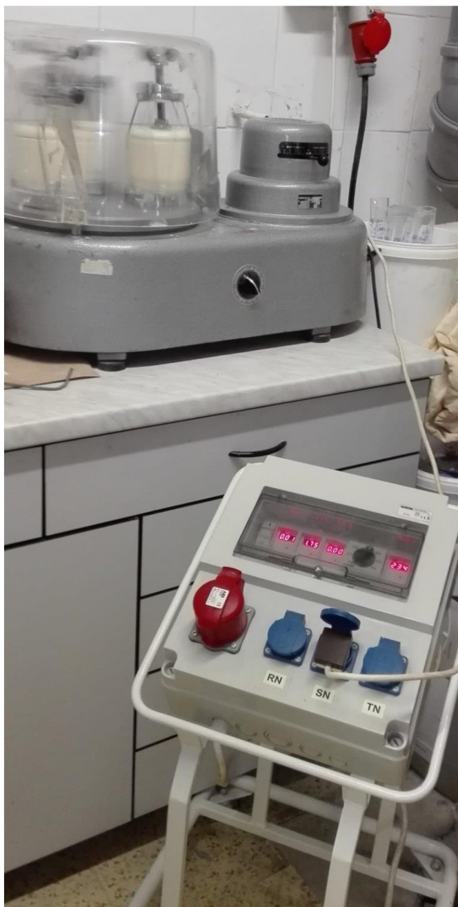
Obrázek č. 16: Měření příkonu planetového mlýna.
