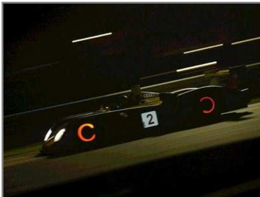
Obr. 2 Závodní vůz s rozžhavenými brzdovými kotouči
