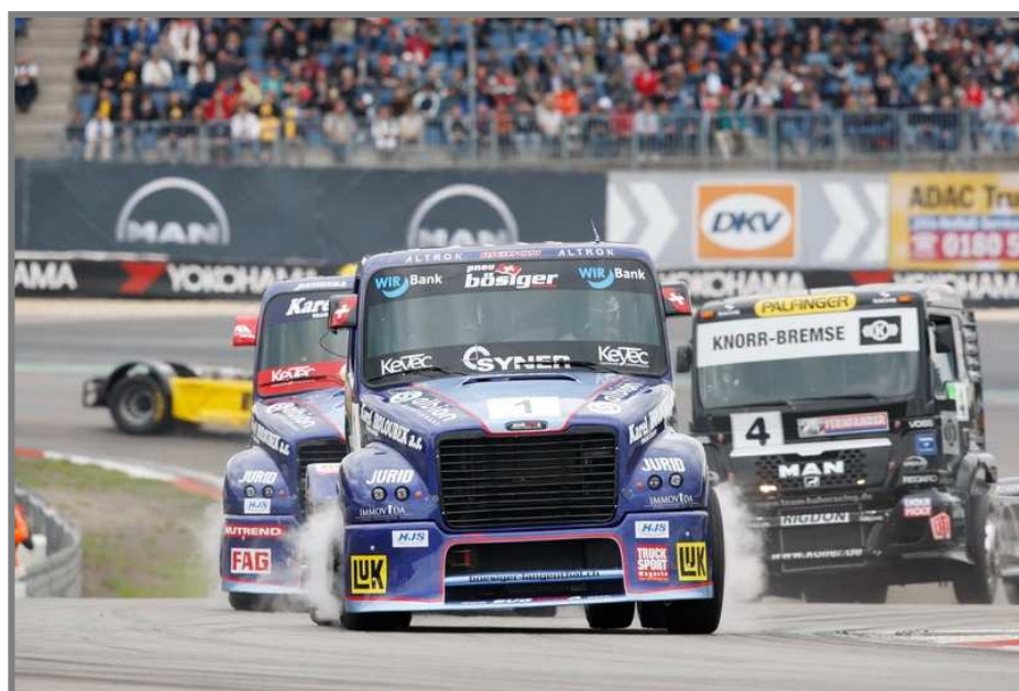
Obr. 6 Vodní pára jdoucí od brzd závodního tahače
