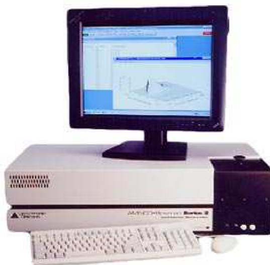
Obr. 5: Luminiscenční spektrofluorimetr Aminco Bowman Series 2 [31]
