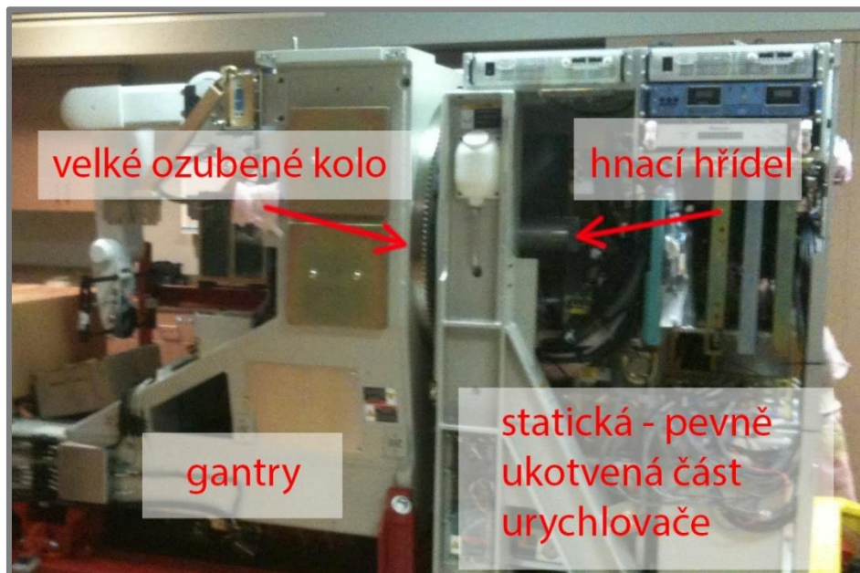
Obr. 2-17 Detail otevřeného lineárního urychlovače [22]
