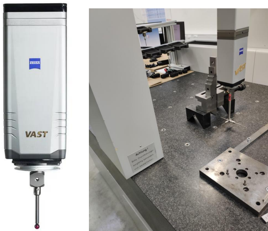
Obrázek 20: snímací hlava Zeiss VAST Gold. Vlevo fotka z katalogu [23]. Vpravo fotka z laboratoře LPM ČMI.
