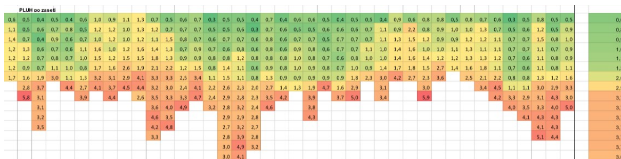
Obr. 7: Penetrometrický odpor půdy (MPa) na variantě ORBA po zasetí (3.4.2016).
