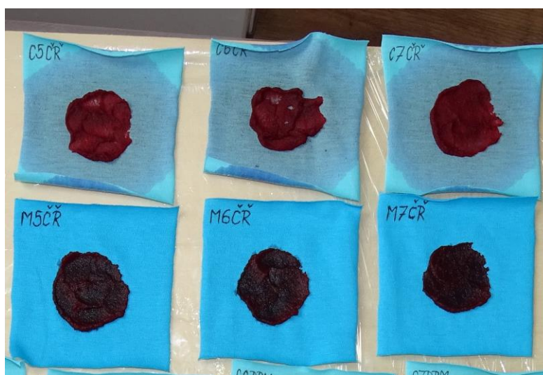
Obrázek 25 Rozdíl pohlcení přebytečné tekutiny ze skvrny mezi vzorky CityZen (horní řada) a vzorky MALFINI (spodní řada)
