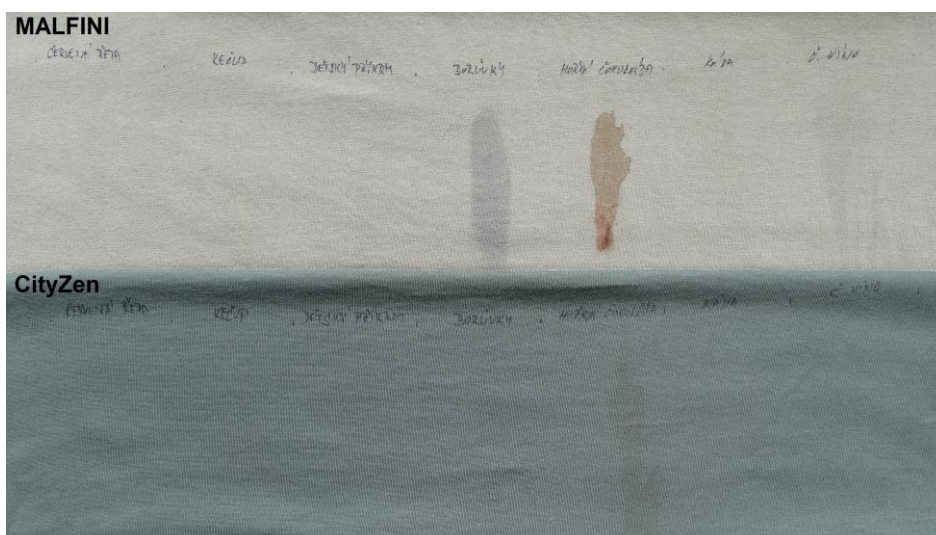
Obrázek 24 Porovnání trik CityZen a MALFINI po odstranění skvrn jemným proudem vody.
