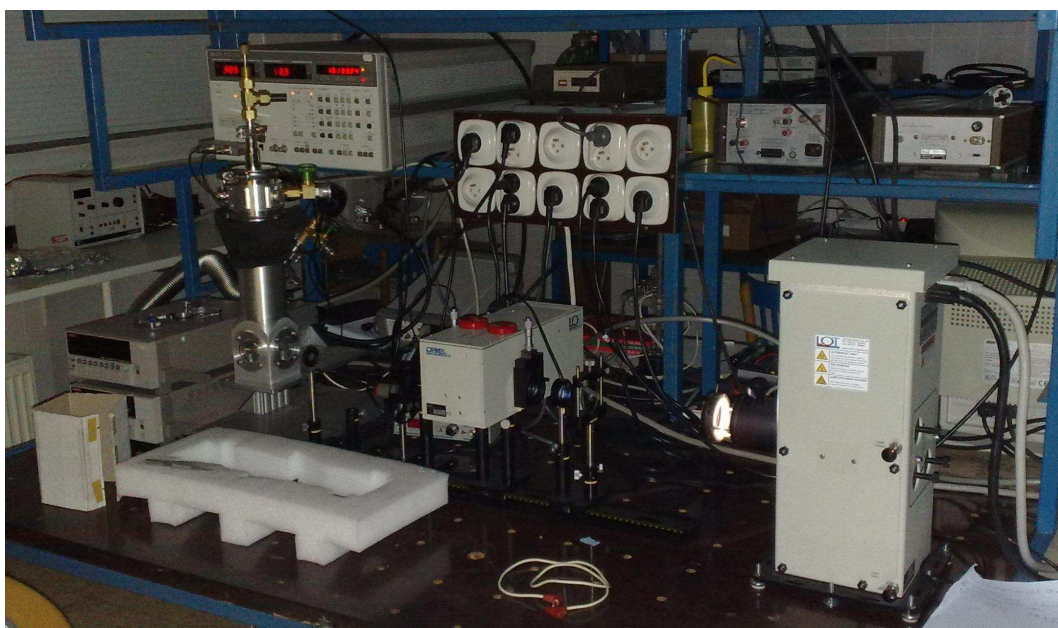
Obr. 22 Měřící pracoviště na určování V-A charakteristik prototypových struktur solárních článků. Zprava: xenonová výbojka, monochromátor, kryostat, picoampérmetr.
