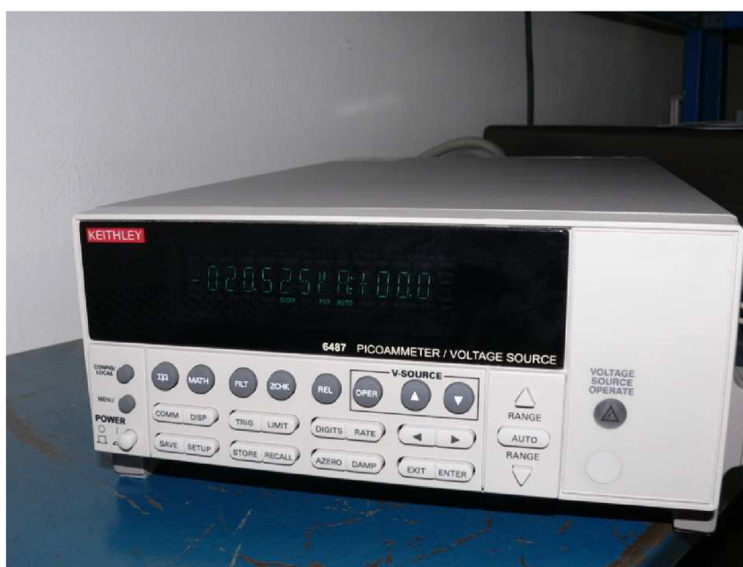
Obr. 21 Picoampérmetr se zabudovaným napěťovým zdrojem (0-500V/50VA stejnosměrných) KEITHLEY model 6487
