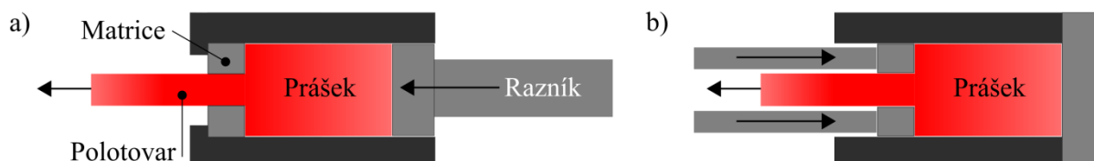
Obr. 12 Způsoby protlačování: a) přímé protlačování b) nepřímé protlačování [10]
