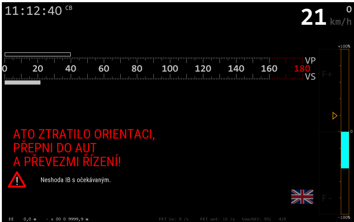
Obr. 4.7 - ATO ztratilo orientaci + identifikace chyby
