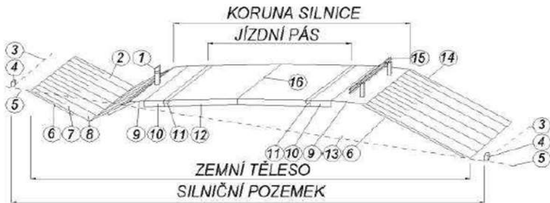
Obr. 3.2 - Příčné uspořádání pozemní komunikace – silnice
