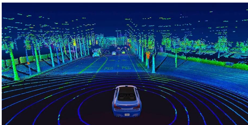
Obr. 4 Výstupem Lidar senzoru je mračno bodů [7]
