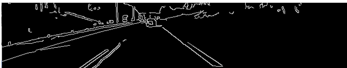
Obr. 31 Snímek po aplikování hranového detektoru Canny
