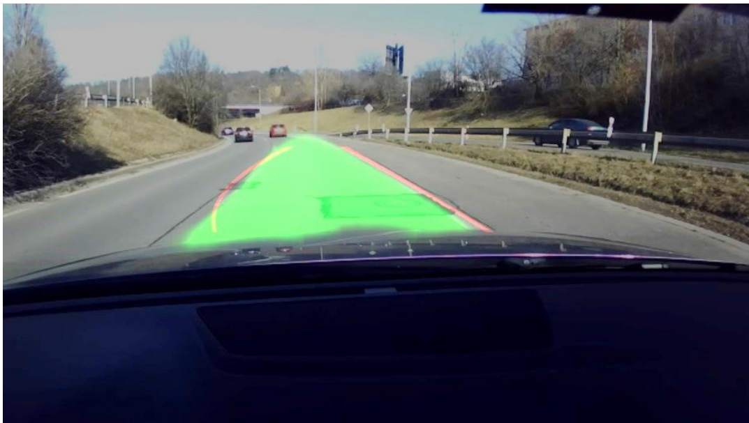
Obr. 43 Špatné vytvoření polynomu při správné segmentaci jízdního pruhu
