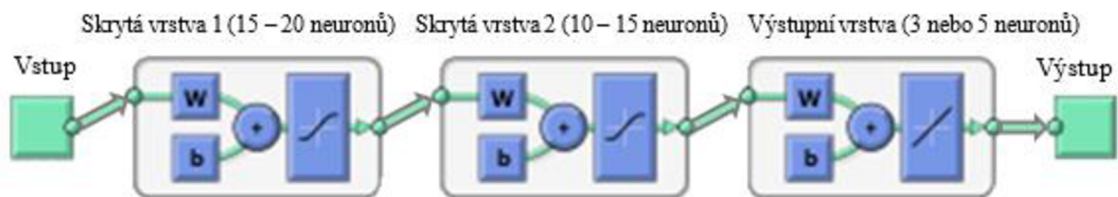
Obr. 22 Schéma neuronové sítě se 2 skrytými vrstvami
