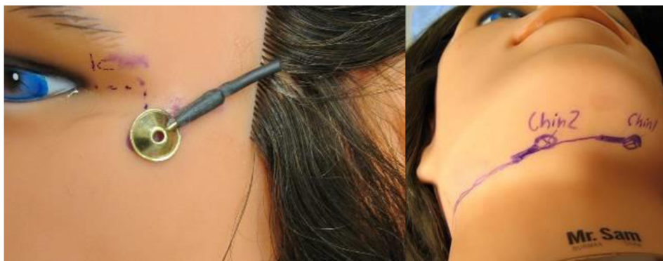
Obr. 8 Umístění elektrod při snímání EOG (vlevo) a EMG signálu (vpravo)
