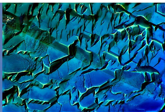
Obrázek 6. Křemíkový krystalický FV článek pod mikroskopem [13]
