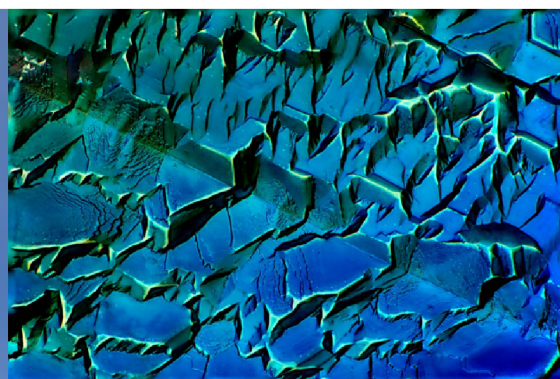
Obrázek 6. Křemíkový krystalický FV článek pod mikroskopem [13]
