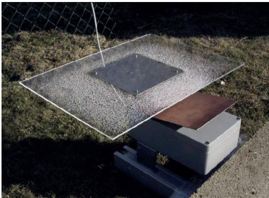
Obrázek 12.: Automatický rosoměr (Zdroj: Fišák 2014)
