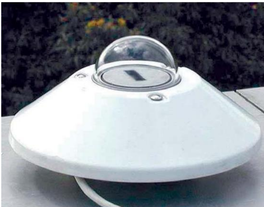
Obrázek 16.: Elektronický slunoměr SD4 se stínícím krytem (Zdroj: Pokorný 2007)
