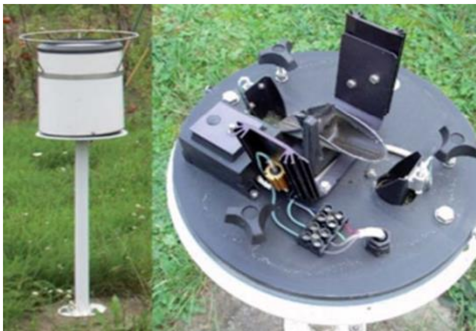
Obrázek 10.: Automatický člunkový srážkoměr MR3H (Zdroj: Kněžínková et al. 2010)
