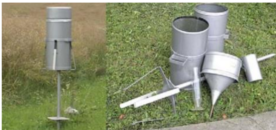
Obrázek 9.: Srážkoměr METRA 886 (Zdroj: Kněžínková et al. 2010)
