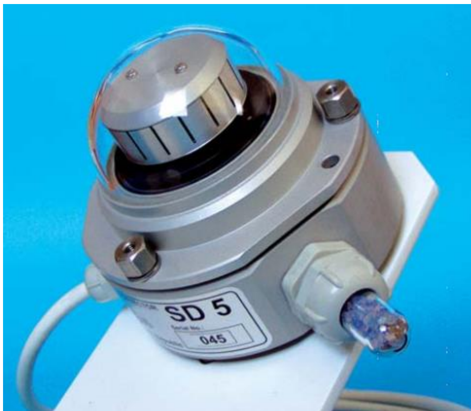
Obrázek 17.: Elektronický slunoměr SD5 (Zdroj: Pokorný 2007)
