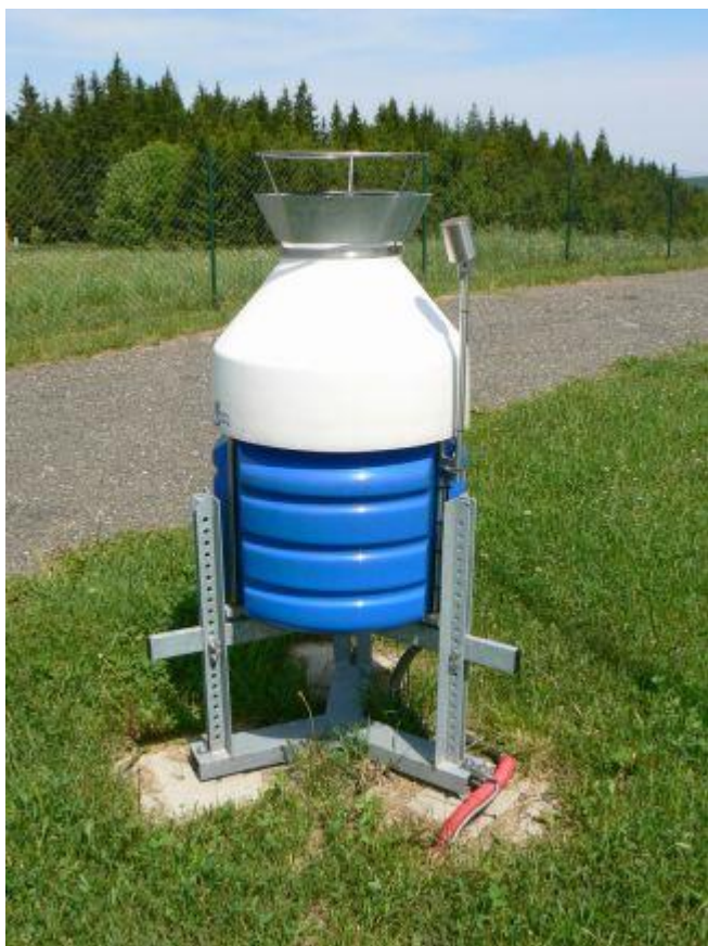
Obrázek 11: Automatický váhový srážkoměr MRW500 (Zdroj: ČHMÚ)
