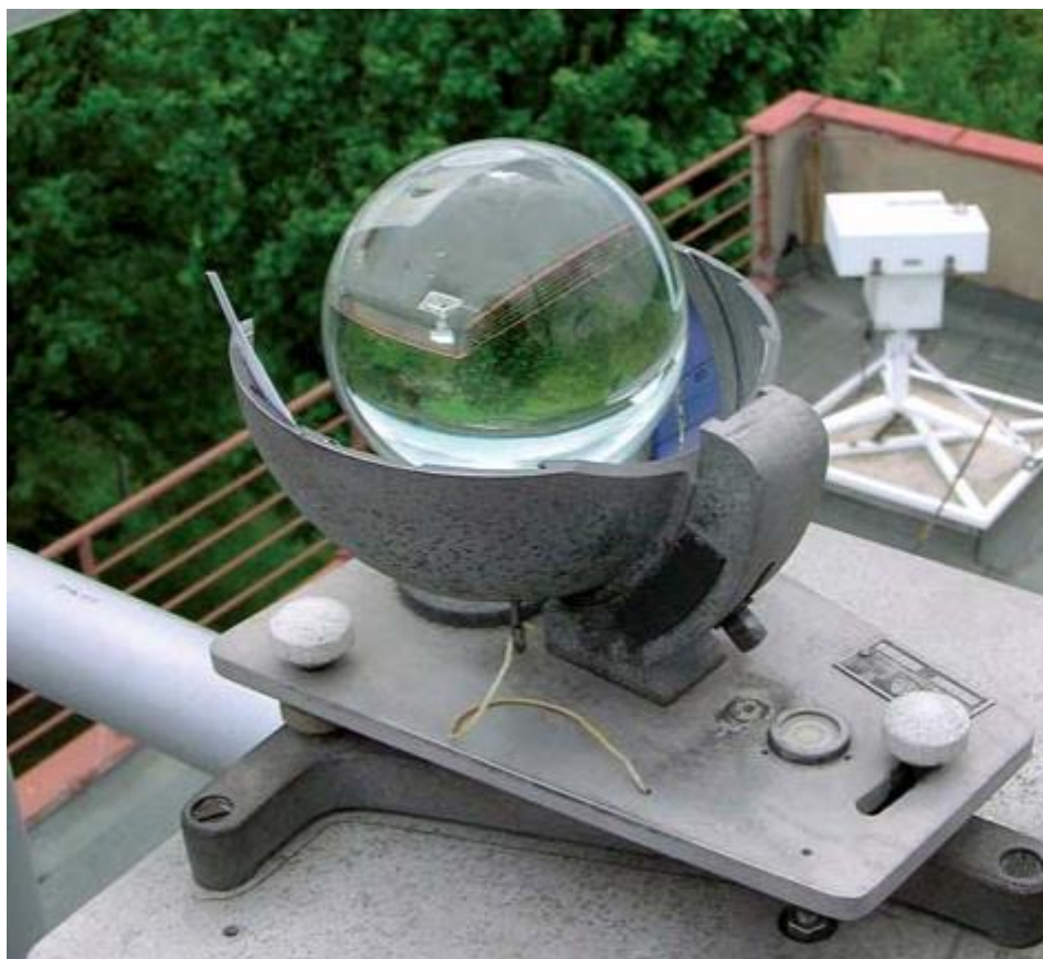
Obrázek 15.: Campbellův-Stokesův slunoměr. (Zdroj: Pokorný 2007)
