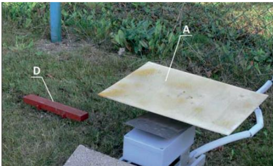
Obrázek 14.: Duvdevaniho (D) a automatický (A) rosoměr při srovnávacím měření na Stanici sledování transportních procesů a půdní vlhkosti na FAPPZ ČZU. (Zdroj: Fišák 2014)
