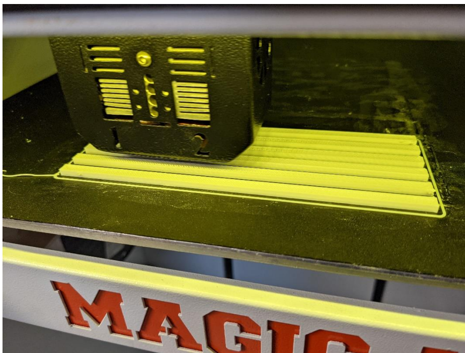
Obrázek 15– Tisk testovacích vzorků (vlastní)
