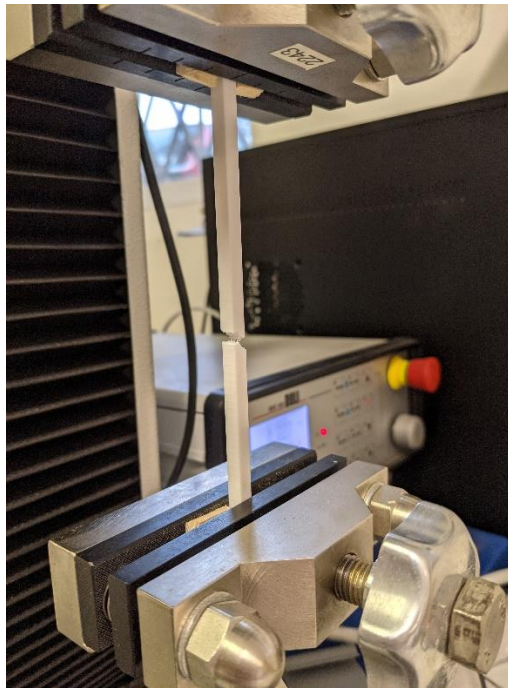
Obrázek 26– Jev přetržení vzorku s vyšší výplní (vlastní)
