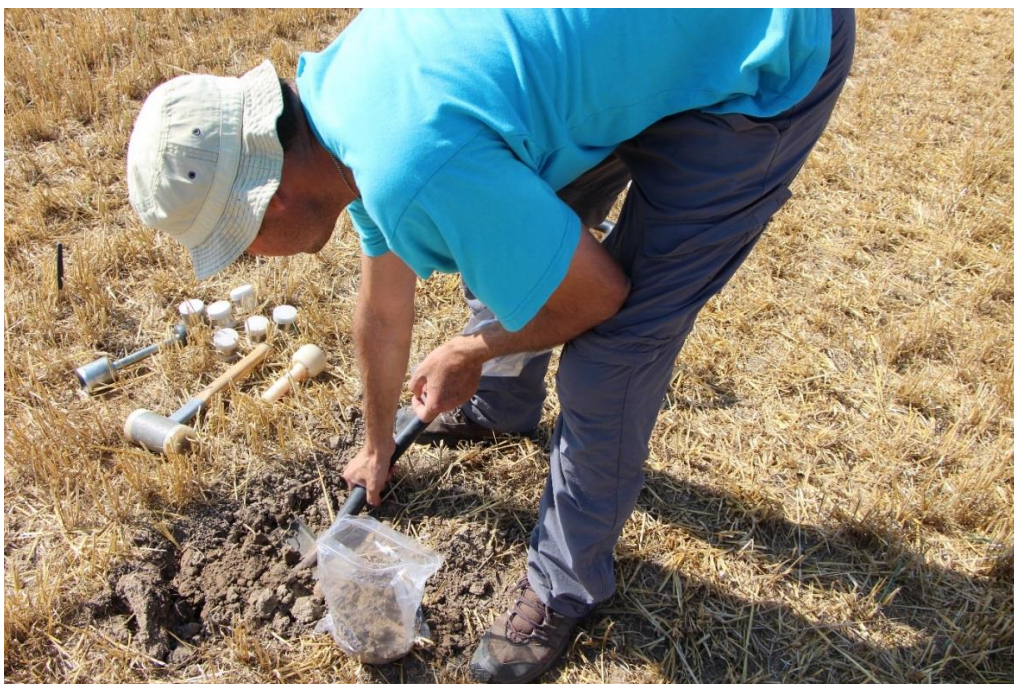
Obr. č. 4. 7 Odebrání porušených půdních vzorků
