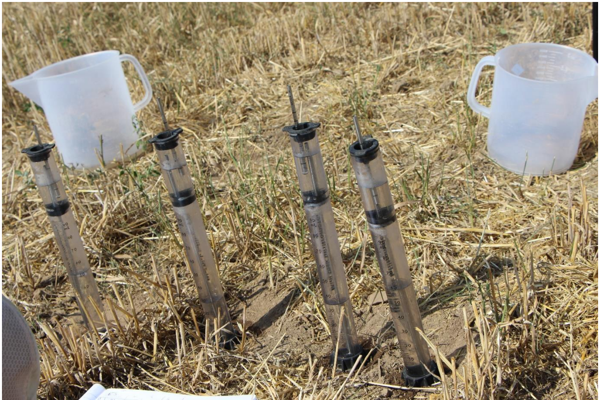
Obr. č. 4. 9 Měření infiltrace vody a etanolu do půdy pomocí minidisc infiltrometrů
