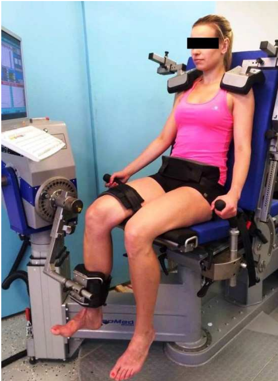
Příloha 3. Poloha probanda během testování izokinetické síly flexorů a extenzorů kolenních kloubů (Xaverova et al., 2015, 260)
