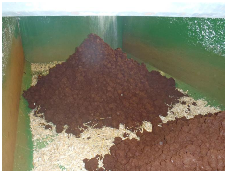
Obr. č. 16 Odvodněný kal na ÚV Mostiště (Zdroj: VAS a. s.)
