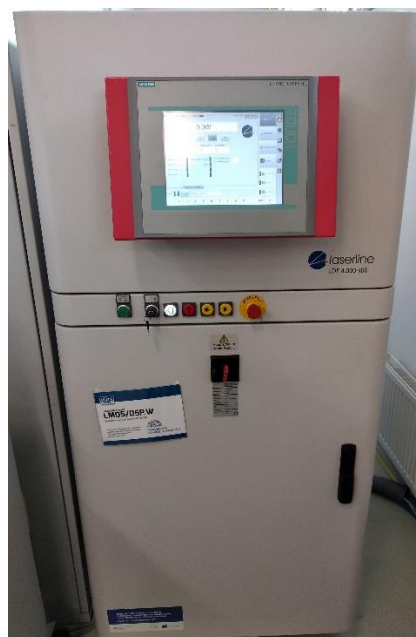
Diodový zdroj laserového paprsku Laserline LDF 4.000-100
