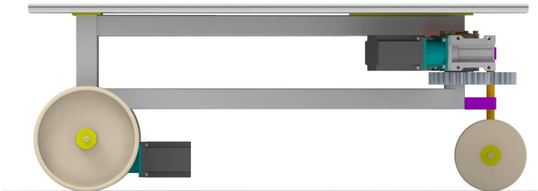
Obrázek 10-3 Upnutí opěrné desky k rámu manipulačního stolu při pohledu z boku [vlastní]
