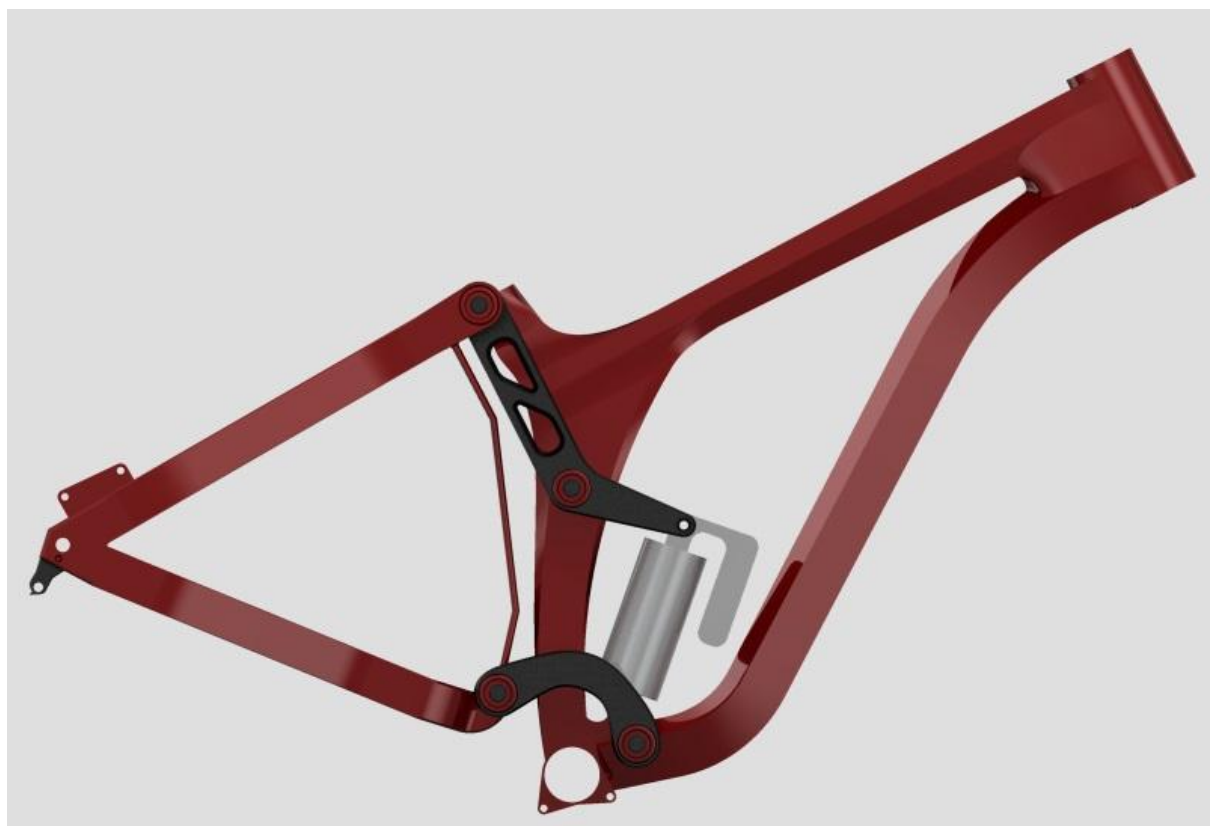
Obr. 24: Vyrendrovaný model sestavy rámového celku v programu Creo Parametric 2.0 (plné stlačení tlumiče)
