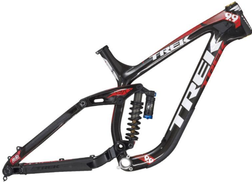
Obr. 10: Sjezdový rám Trek Session 9.9 se systémem ABP [25]
