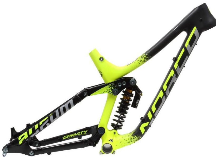
Obr. 11: Sjezdový rám Norco Aurum se systémem FSR [26]
