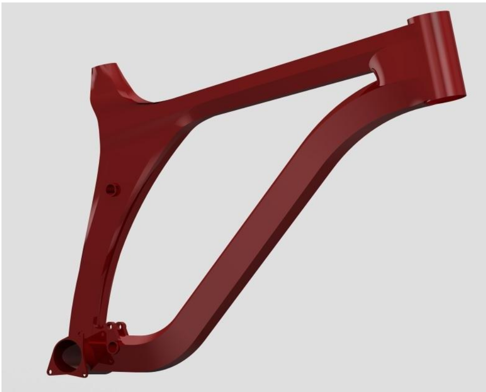
Obr. 19: Vyrendovaný model předního rámového trojúhelníku v programu Creo Parametric 2.0
