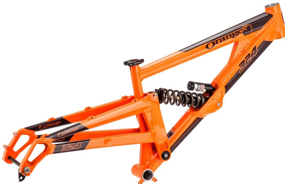
Obr. 8: Sjezdový rám Orange 324 (dvoučlenný mechanismus) [23]
