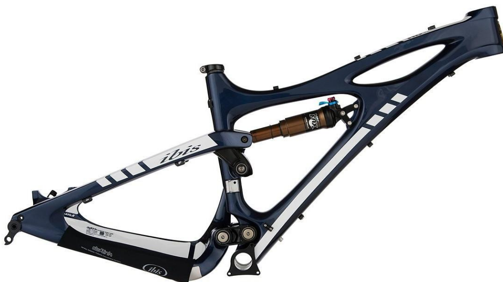
Obr. 12: Enduro rám Ibis Mojo HDR využívající systém DW-link [27]
