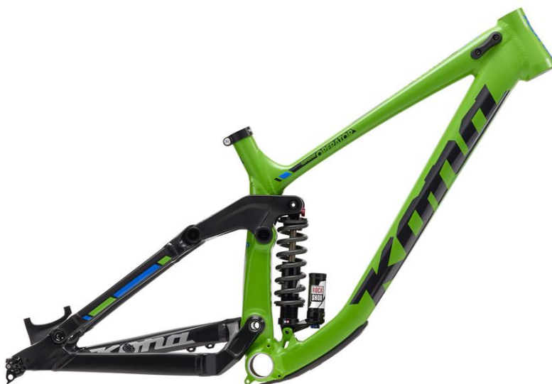
Obr. 9: Sjezdový rám Kona Operator 2016 (jednočepový systém s přepákováním) [24]
