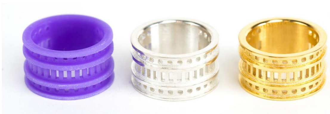
Obr. 4 Model a následný odlitek zhotovený metodou ztraceného vosku. Zdroj: https://www.projct-3d-drucker.de/3d-drucker/wachsdruker/
