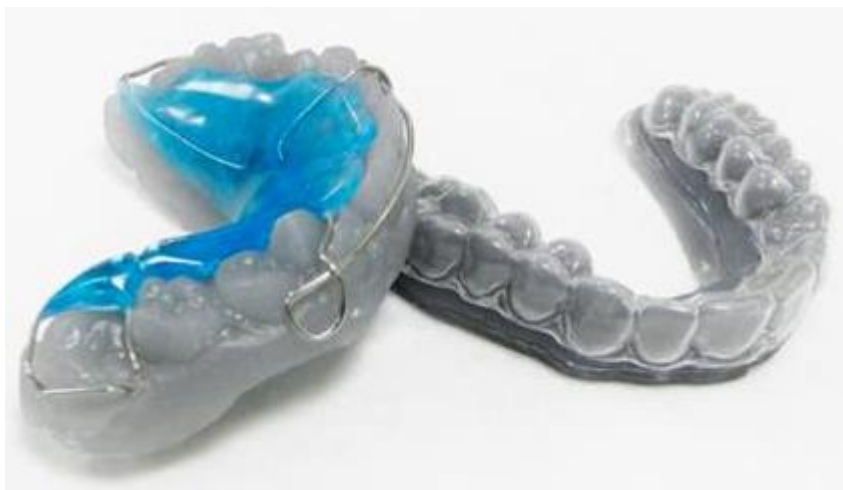
Obr. 10 Model čelisti pro výrobu rovátek vytištěný metodou SLA.
