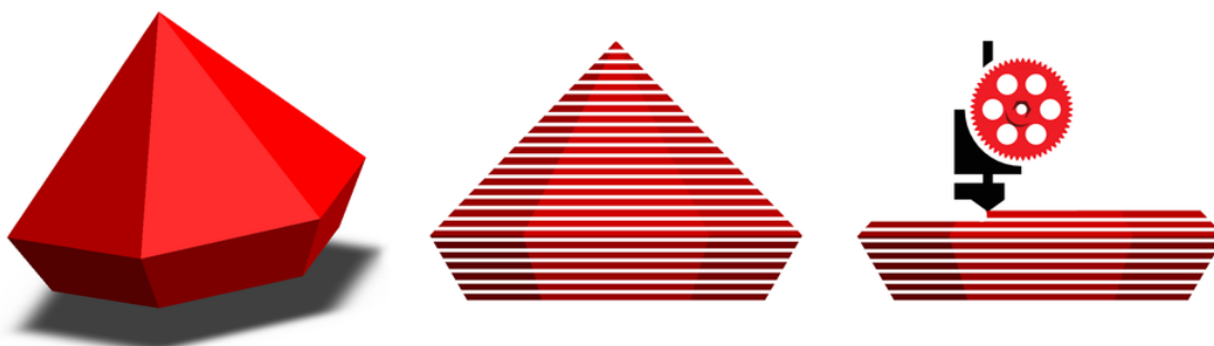
Obr. 1 Princip 3D tisku - model, „naplátkovaný model“ 3D tisk. Zdroj: https://hotmess3d.com/en/iimg/265/950x/i.png
