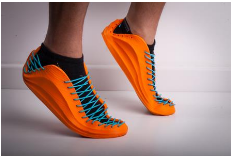
Obr. 8 Boty vytištěné z elastického materiálu metodou FDM. Zdroj: http://www.fabbaloo.com/blog/2014/1/1/filaflex-is-indeed-flexible.html
