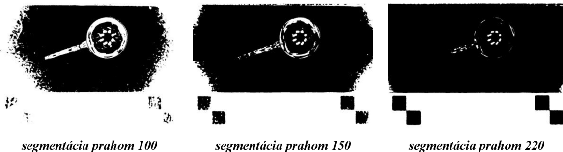
Obrázok 8.7: Segmentácia obrazu a) prahom 100, b) prahom 150, c) prahom 220 (vlastný zdroj)
