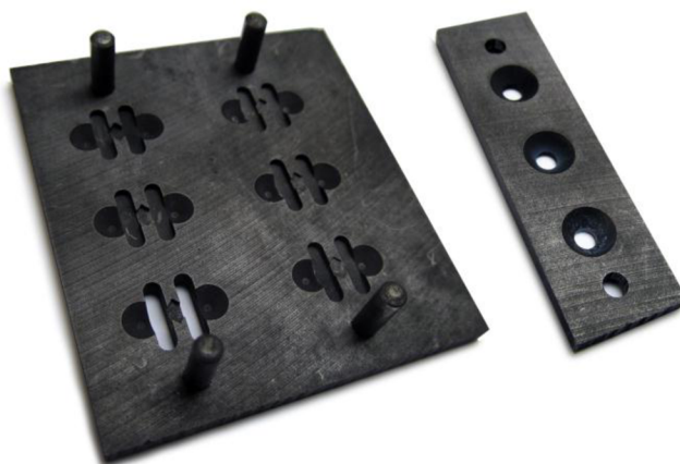
Obrázok 6.3: Grafitová doska pre polohovanie súčiastok typ 2 (vlastný zdroj)
