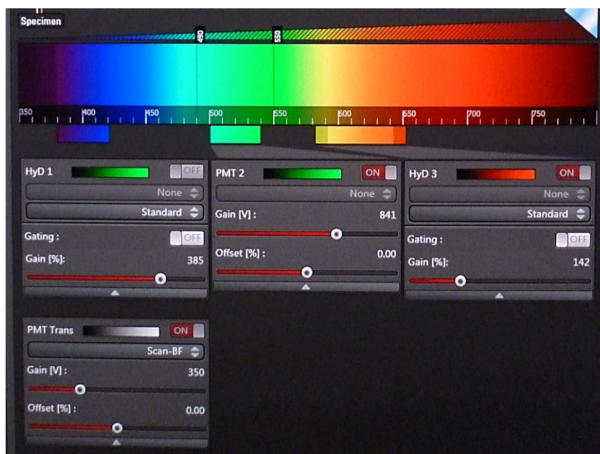
Obrázek 34: Ukázka nastavování detektorů v Leica softwaru. V tomto případě je zapnut fotonásobič 2 (emisní filtr 500-540 nm), hybridní detektor 3 (emisní filtr 580-650 nm) a fotonásobič pro detekci prošlého světla.
