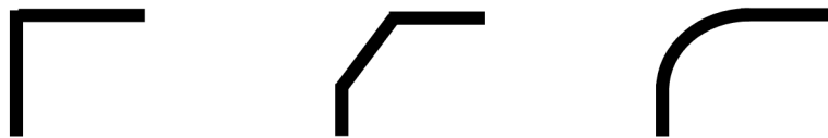
Obr. 28: Možnosti provedení ohybu napájecího rozvodu, ohyb 90^\circ , ohyb 45^\circ a zakulacený ohyb.
