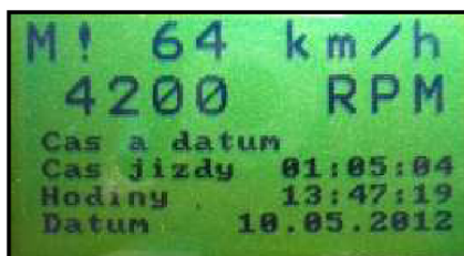
Obr. 56: Signalizace při překročení povolené teploty motoru.
