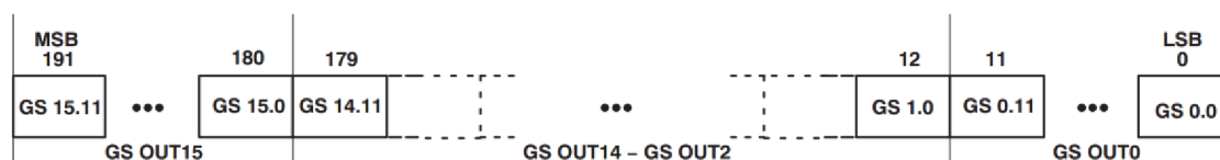
Obr. 13 Formát vstupních dat pro řízení jasu LED diod pomocí obvodu TLC5940 (převzato z [8])
