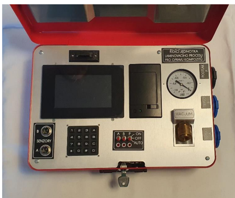
Obrázek 44 - Řídicí jednotka, pohled na přístrojový panel
