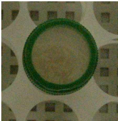
Obr. 9: Speciálně upravené víčko plastové zkumavky s tkaninou Uhelon.
