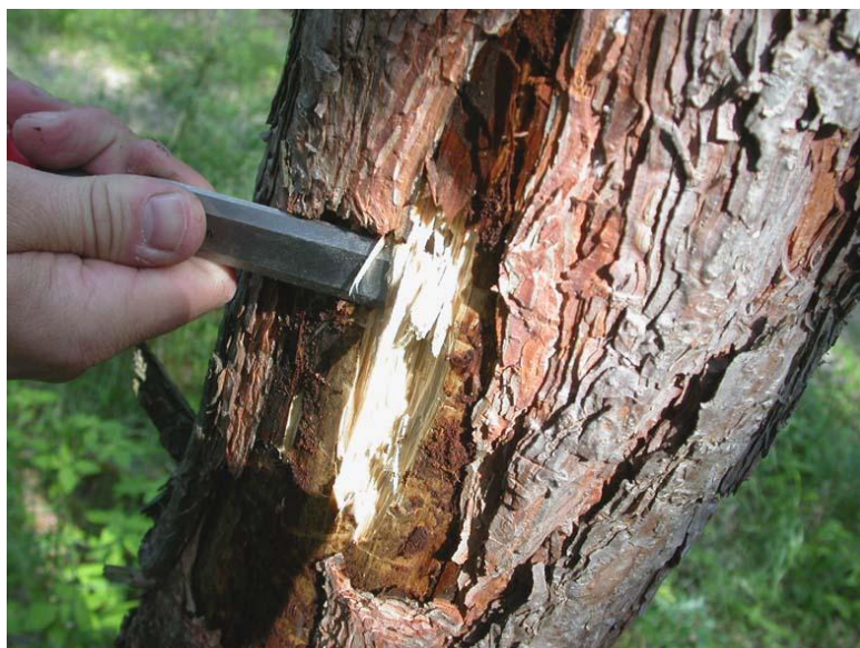
Obr. 4: Odběr dřeva pomocí dláta (Zouhar a kol., 2007).
