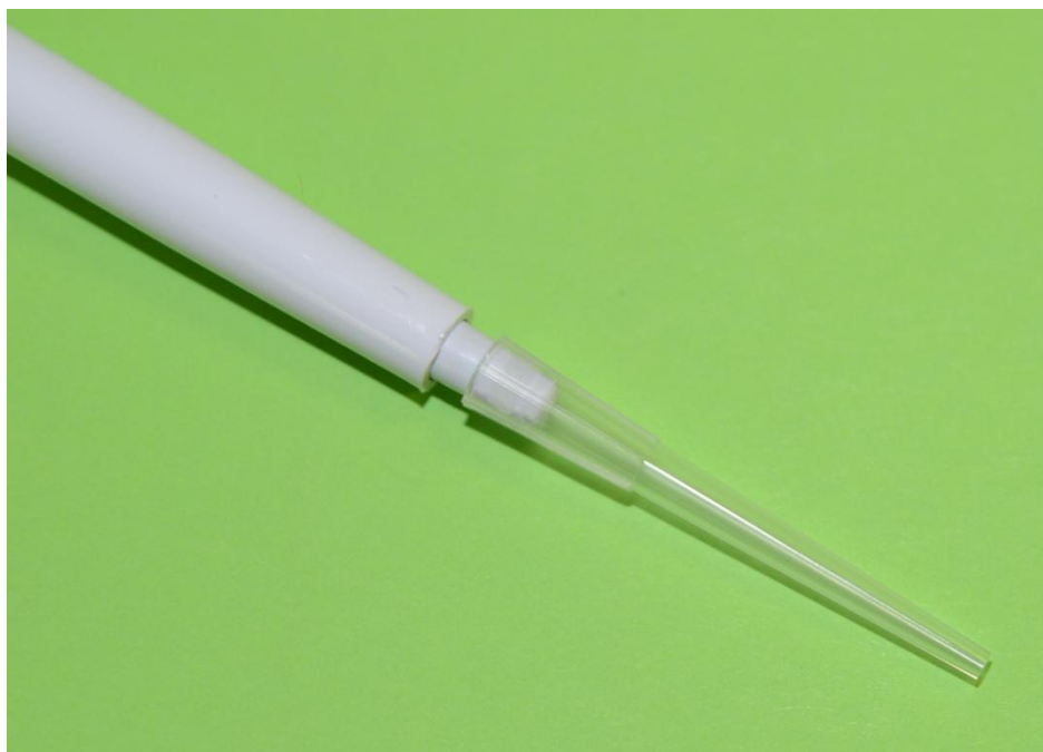
Obr. 8: Široká špička pro pipetování suspenze silic.
