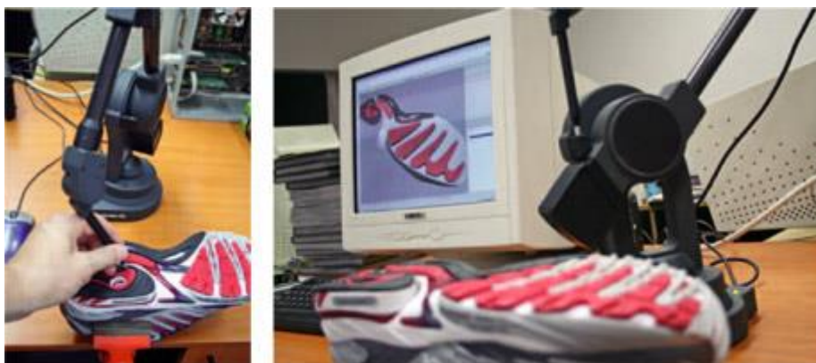
(Ukázka moderní ruční digitalizace objektu www.cad.cz )
