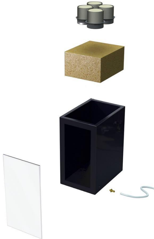
Obr. 7. Schéma měřícího aparátu (sestupně): válečky se vzorky substrátu, minerální vata, box. Přední polykarbonátová deska (vlevo), výpustný ventil (vpravo).
