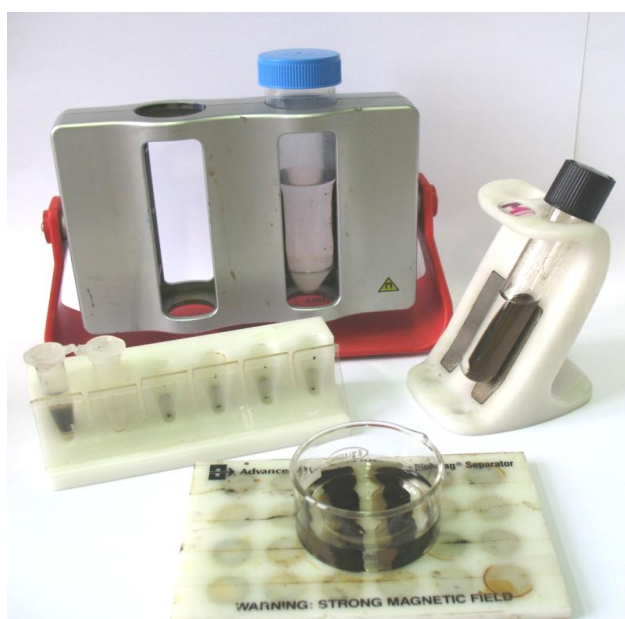
Obrázek 4: Ukázka magnetické separace pomocí různých typů komerčně dostupných vsádkových magnetických separátorů.
