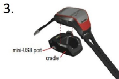
Obrázek 7. Sporttester Garmin Forerunner 305 (1.), hrudní pás – vysílač (2.), USB kolébka (3.), kabel USB pro propojení s PC (4.)
