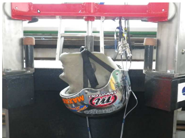
Obr. 4-10 Upevnění helmy na impaktor
