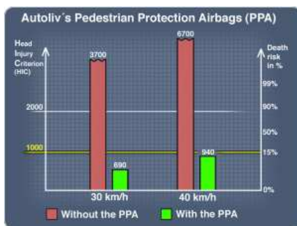
Obr. 3-14 Graf porovnání testu bez a s airbagem pro chodce
