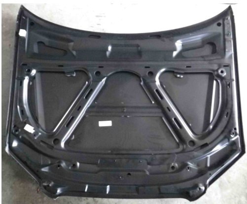
Obr. 4-8 Nosná konstrukce kapoty Audi A4
