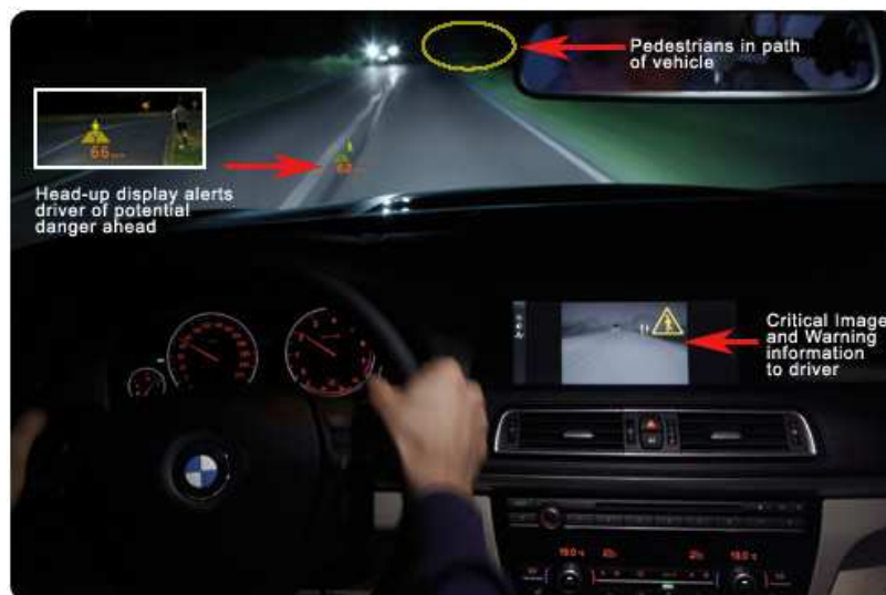
Obr. 3-17 Obraz zobrazený řidiči při oslnění protijedoucím vozem
