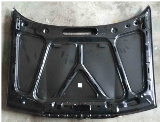
Obr. 4-5 Nosná konstrukce kapoty Škoda Fabia
