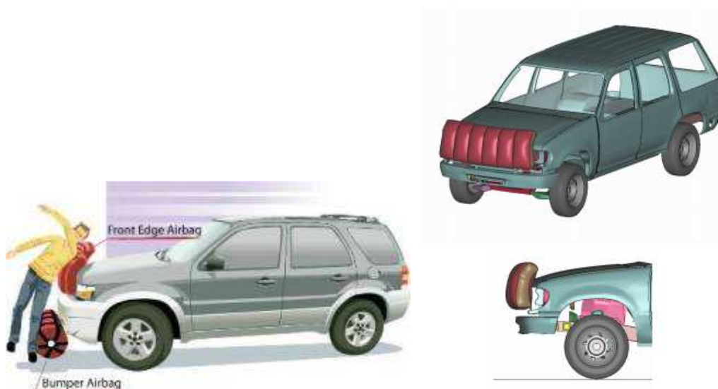
Obr. 3-15 Airbag pro chodce u vozů SUV (Front Edge Airbag)
