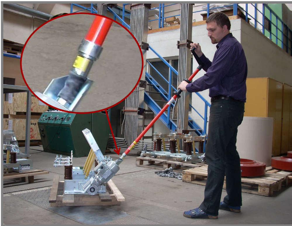
Obr. 2-2 Ukázka použití pojistné spojky
