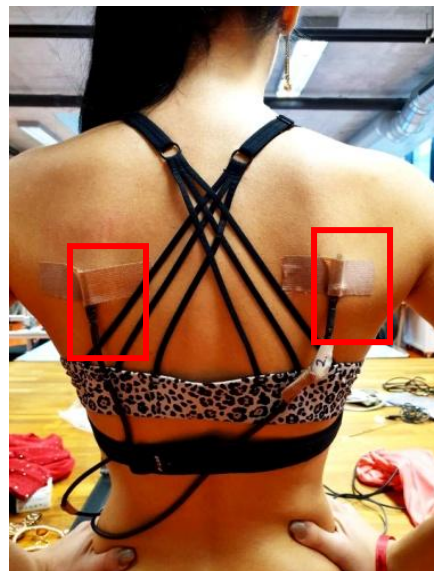
Obr. 22: Umístění levého a pravého senzoru na zadní části těla probanda pomocí lepicí pásky
