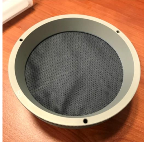
Obr. 19: Miska s vodou a upnutým vzorkem
