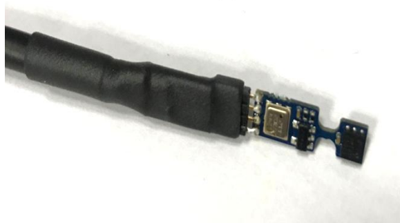
Obr. 20: Senzor AHLBORN ALMEMO FHAD460 relativní vlhkosti a teploty vzduchu
