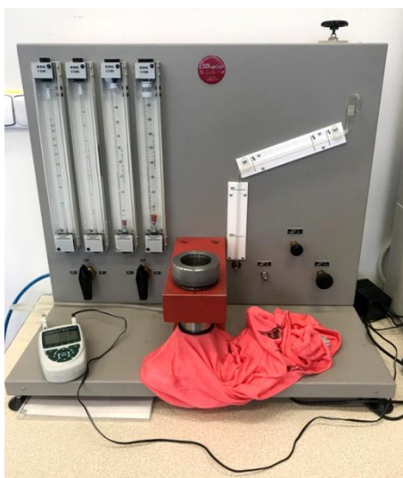
Obr. 12: Přístroj SDL M021S s upnutým vzorkem
