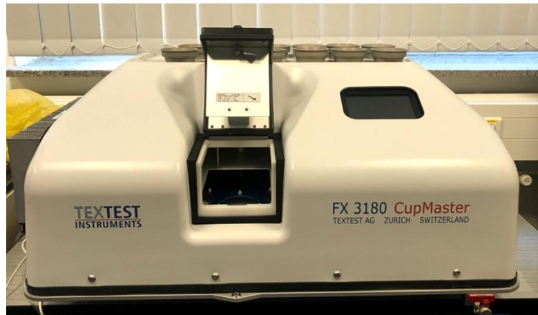
Obr. 17: Příklad přístroje FX 3180 CupMaster pro určení propustnosti vodních par
