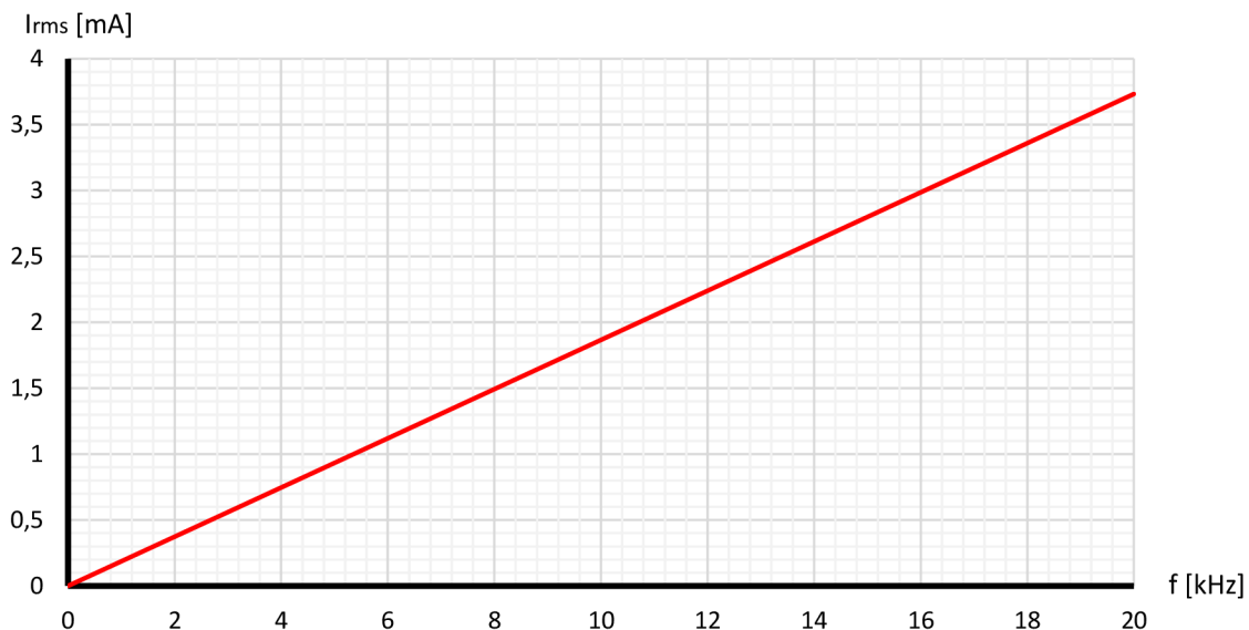
Obrázek 2-2 Závislost potřebného proudu na frekvenci
