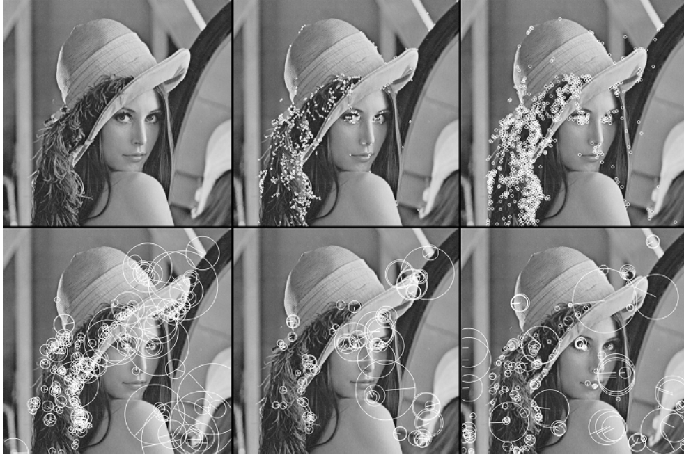
Obrázek 2.1: Ukázky význačných bodů pořízených různými detektory. Zleva: Originální obrázek, Harrisův detektor, FAST, DoG (Difference of Gaussians), DoH (Determinant of Hessian), MSER (Maximally stable extremal regions).
