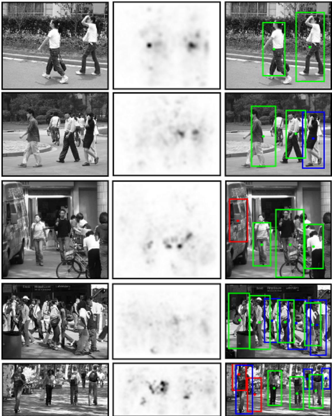
Obrázek 5.22: Detekce chodců, PennFudan pedestrians. Zleva: originální obrázek, hlasovací prostor, výsledek detekce. Zeleně True positive, Červeně False positive, Modře False negative
