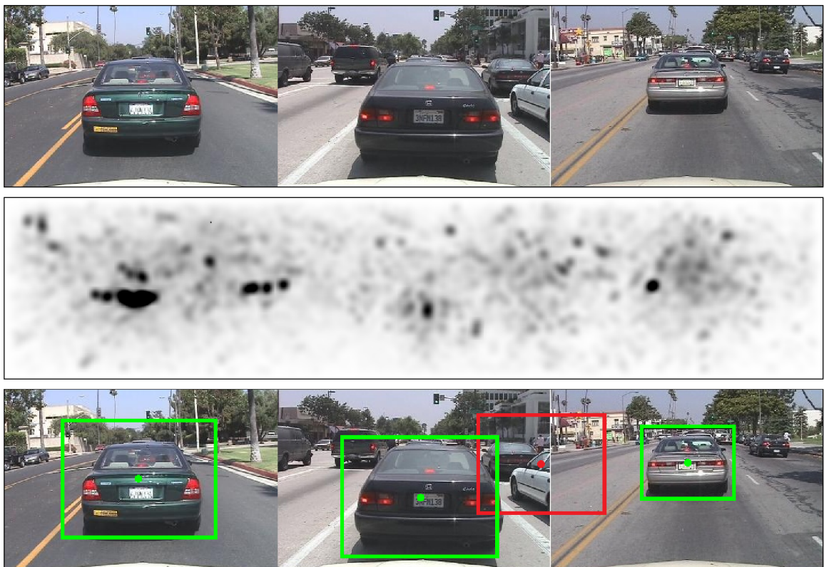
Obrázek 5.25: Detekce zádň části automobilů.
