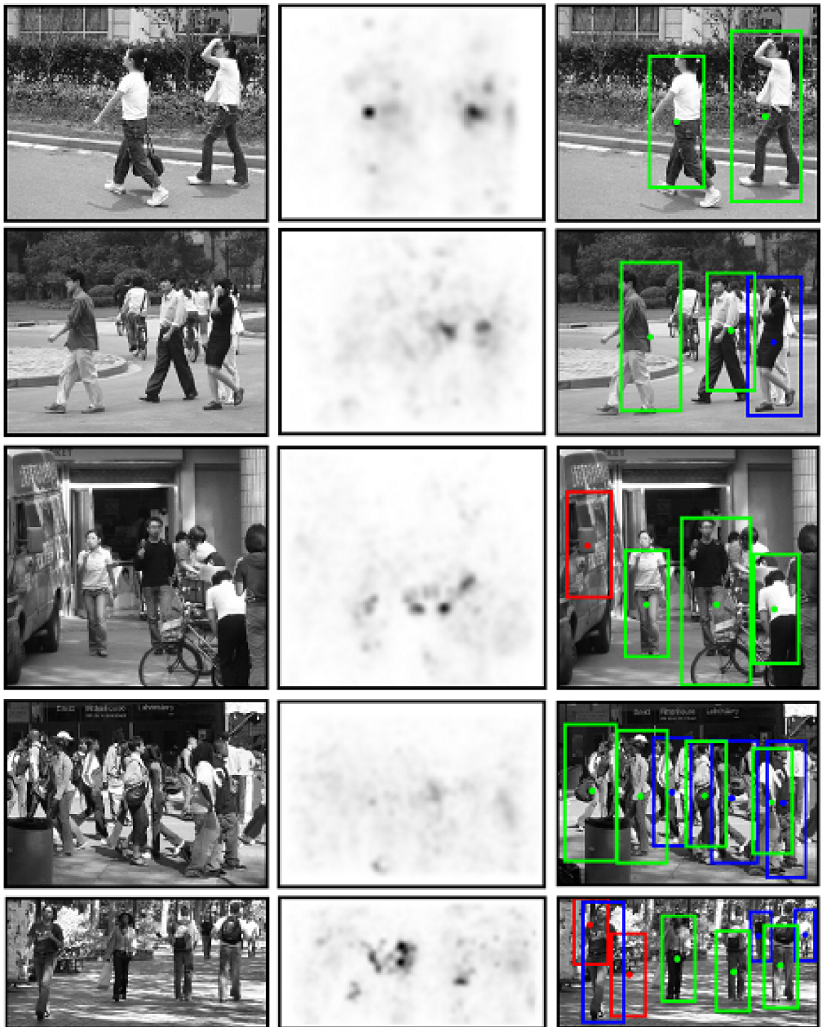
Obrázek 5.22: Detekce chodců, PennFudan pedestrians. Zleva: originální obrázek, hlasovací prostor, výsledek detekce. Zeleně True positive, Červeně False positive, Modře False negative
