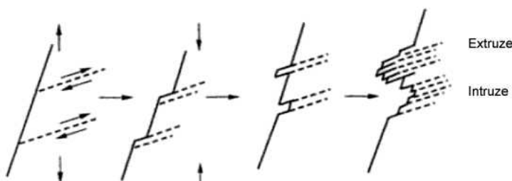
Obr. 9 Vznik extruzí a intruzí při cyklickém namáhání [16]
