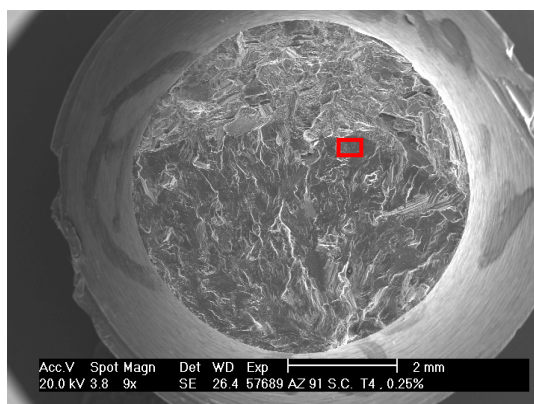
Obr. 40 Lomová plocha slininy AZ91 (T4, \varepsilon_{at} = 0,25 \% , N_f = 34173 cyklů, REM)
