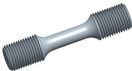
Obr. 15a 3D model zkušební tyče
