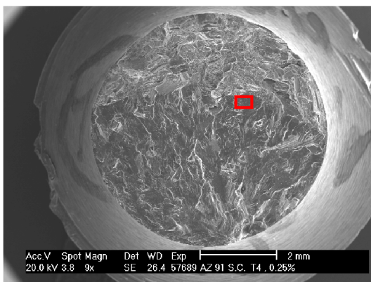
Obr. 40 Lomová plocha slininy AZ91 (T4, \varepsilon_{at} = 0,25 \% , N_f = 34173 cyklů, REM)
