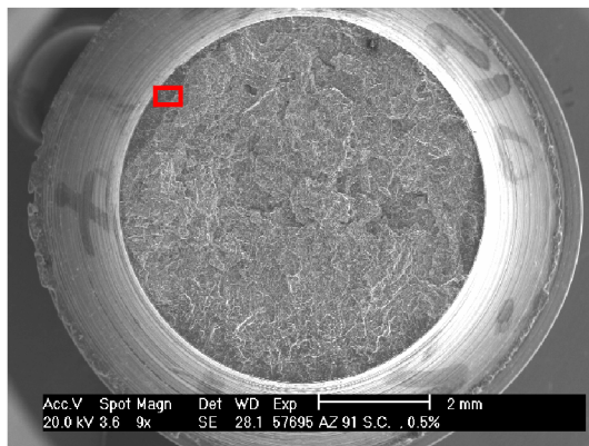
Obr. 34 Lomová plocha slitiny AZ91 (L.S., \varepsilon_{at} = 0,5 \% , N_f = 1580 cyklů, REM)
