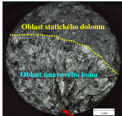
Obr. 36 Lomová plocha slininy AZ91 (T4, \varepsilon_{at} = 0,25 \% , N_f = 34173 cyklů, SM)
