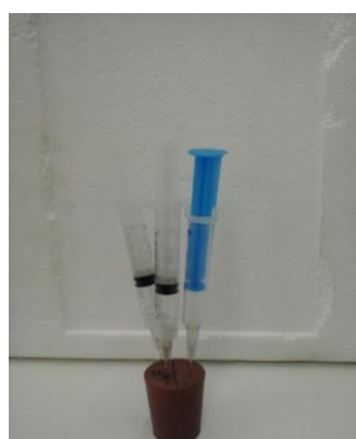
Obr č. 11: Odebrané vzorky vzduchu z Erlenmayerovy baňky v injekčních stříkačkách
